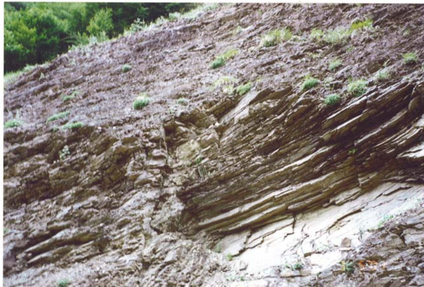
شکل ( ۵ ) تخریب ورقه‌ای در شیستهای دره ماسوله
